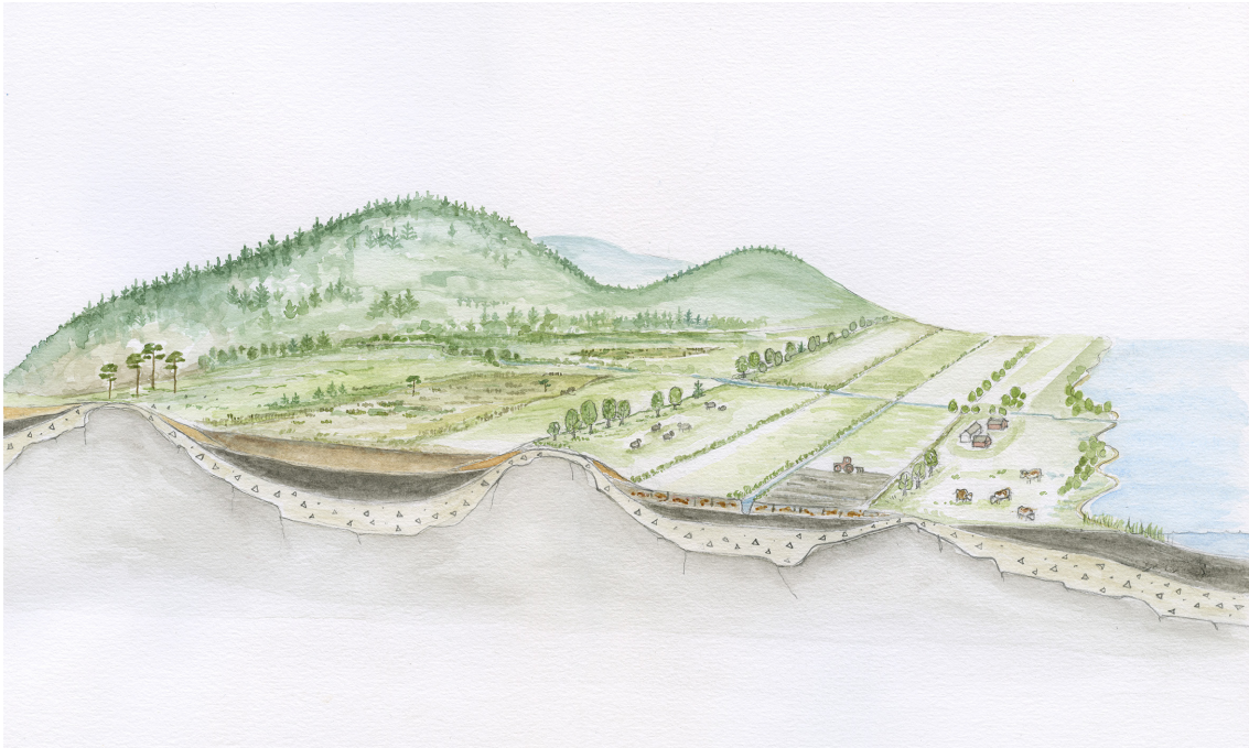
Figur 3. Illustrationen visar ett område med potentiell sur sulfatjord som lyfts upp till följd av landhöjningen. I det uppodlade området har aktiv sur sulfatjord (rostfärgat lager) bildats som en följd av att grundvattenytan sänkts genom dikning. I myrområdet har ingen markavvattning skett och därmed har den potentiellt sura sulfatjorden inte exponerats för luft utan ligger kvar under ett lager av torv. Närmast kusten har marken inte påverkats av markavvattning och den potentiellt sura sulfatjorden är opåverkad av oxidation. Genom landhöjningen kommer dock dessa områden i framtiden att kunna utgöras av dikad jordbruksmark. Illustratör: Magdalena Thorsbrink.
