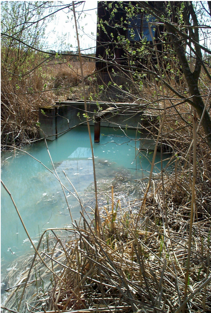
Figur 17. Aluminiumutfällningar i ett vattendrag nära Mälaren. När det sura vattnet från aktiv sur sulfatjord möter dikesvattnet, som har ett högre pH, faller aluminiumhydroxider ut. Området med sur sulfatjord är invallat och har torrlagts genom att vatten pumpas ut. I bakgrunden syns en pumpstation.
