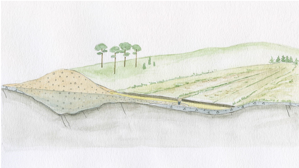
Figur 8. Genomsnitt av en utdikad torvmark som gränsar till en rullstensås med ett grundvattenmagasin. Den gula färgen åskådliggör lerlagret under torven, som i sin tur vilar på det mer genomsläppliga åsmaterialet (beige färg med runda ringar). Därunder finns moränlagret (gråblåfärg) som vilar på berggrunden.
