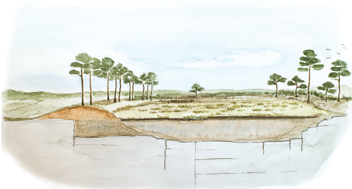
Figur 1. Återskapad våtmark i ett utdikad torvområde. I själva torvområdet ökar grundvattenbildningen endast marginellt om ens något. Faktum att man uppehåller vattnet i landskapet och därmed får ett varaktigare och jämnare flöde under året skapar dock förutsättningar för en ökad grundvattenbildning på andra platser. Kontinuerligt läckage och grundvattenbildning kan ske i de tidigare strandzonerna där det finns infiltrationsbenägna jordar (t.ex. sand).
