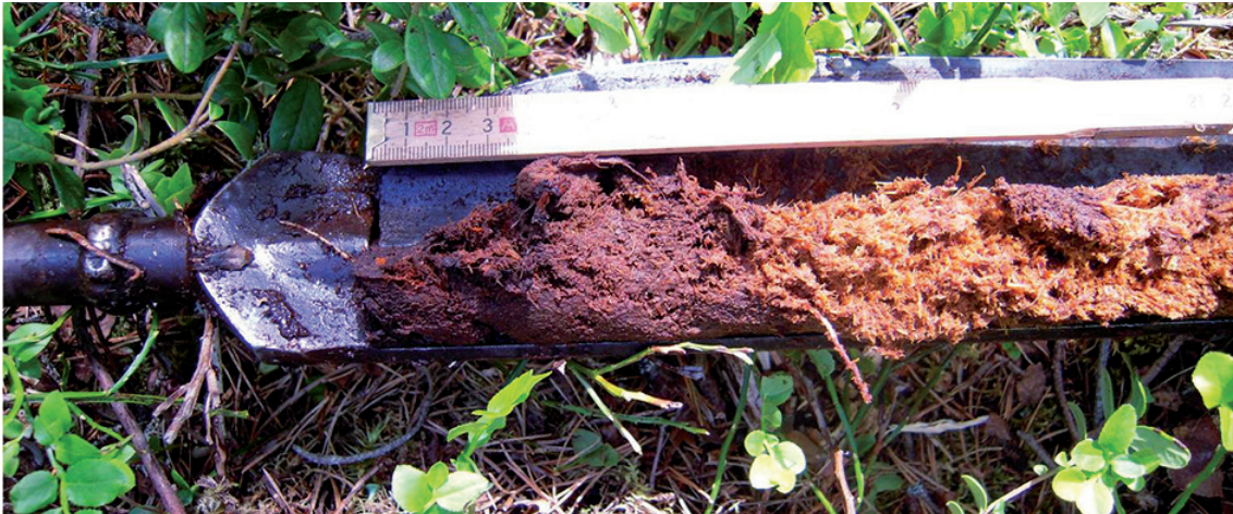
Figur 6. Höghumifierad torv i ytan på torvmarken. Vid undersökningarna i samband med linjeinventeringen hade torven samma låga humifieringsgrad hela vägen upp till markytan.
