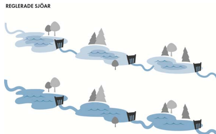
Figur 3. Bilderna illustrerar ett reglerat system där det finns möjlighet att hålla en jämnare vattenföring i vattendraget. Den övre bilden visar ett lågflödestillfälle och den nedre ett högflödestillfälle.
