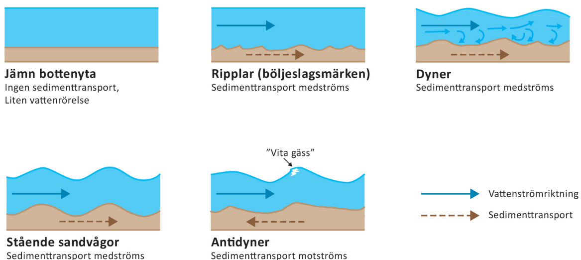
Figur 1. De olika mönster eller ytformer sand får vid bottentransport vid ökande strömhastighet och skjuvspänning. Illustration: Fredrik Saarkoppel.
