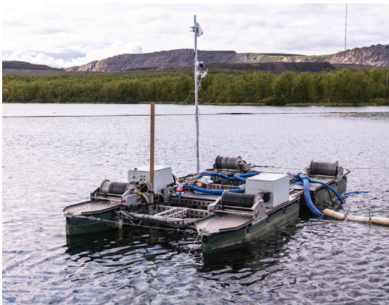
Pilotförsök med densitetsstyrd lågflödesmuddring och avvattning av förorenade sediment i så kallade geotuber i Ala Lombolo, Kiruna kommun. SGU ansvarar för att genomföra fler pilotförsök för att testa åtgärds tekniker inom RUFFS.
