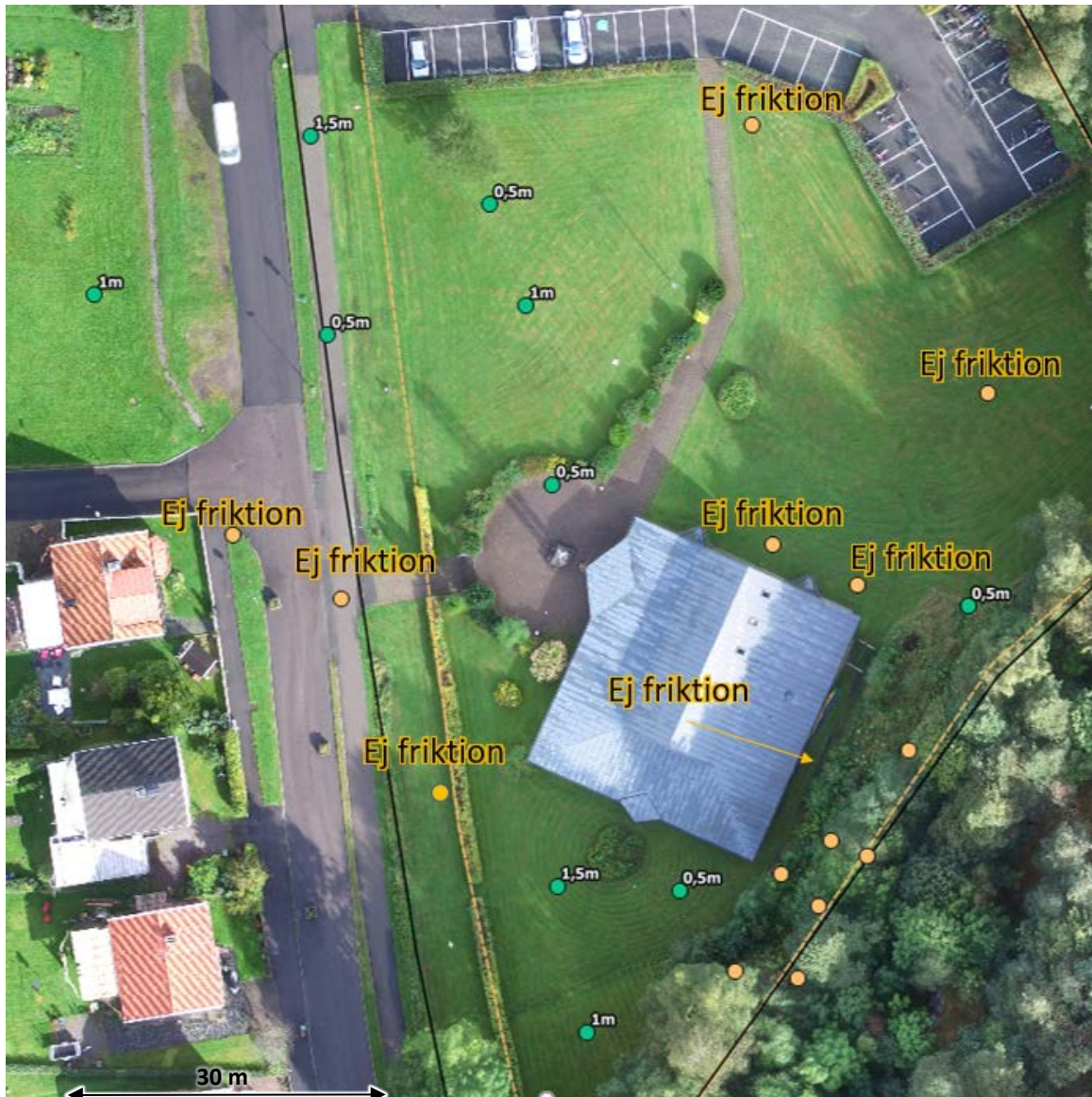
Figur 12. Mäktighet (m) av friktionsjord under leran , se gröna punkter. I bruna punkter har ingen friktionsjord påvisats (stopp mot förmodat berg).
