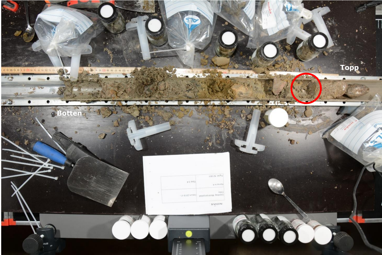
Figur 4.3: Jordkärna NI1801 3 - 4 m efter provtagning av jord till PID-mätning och kemisk analys. Provttag med misstänkt korskontaminering till följd av nedfallet material har markerats med röd ring.
