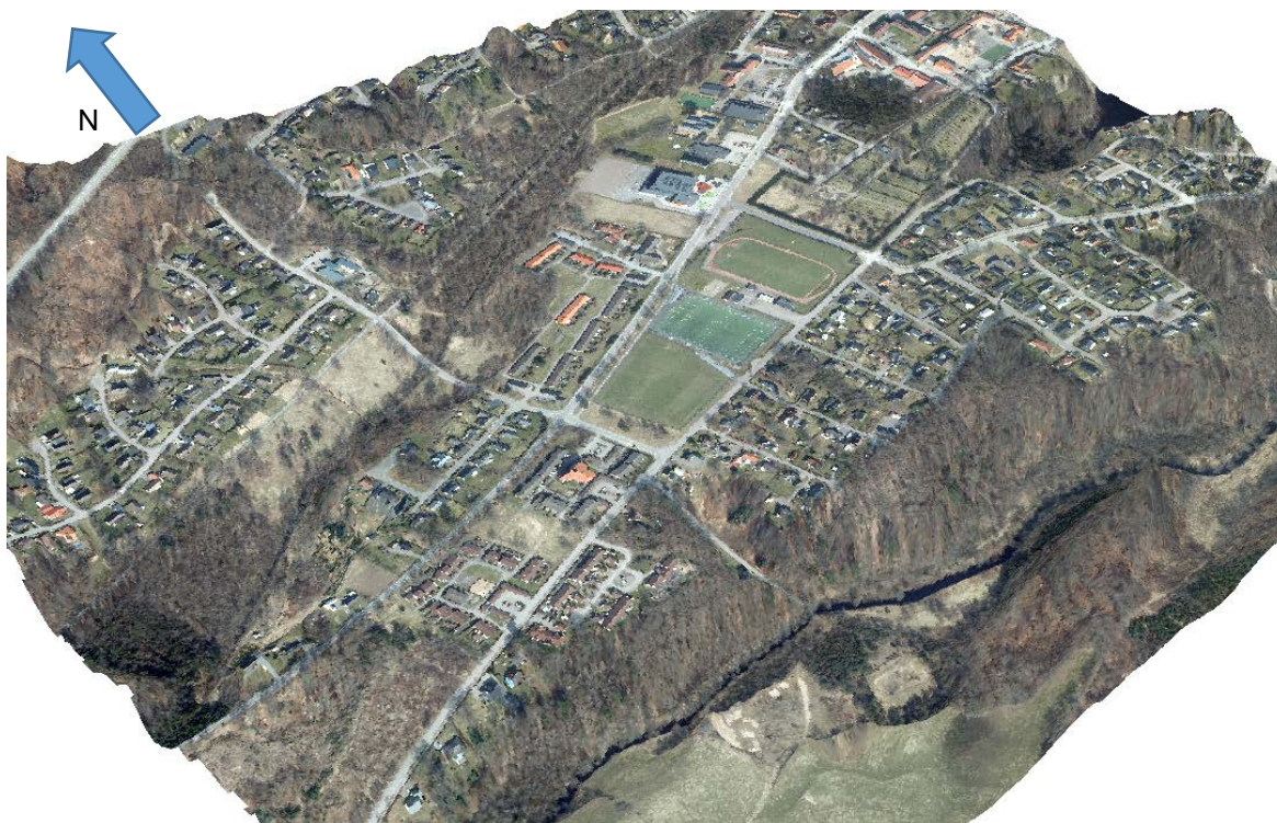
Figur 2: Topografisk 3D-modell, där höjdsckalan är överdriven 5 gånger. 3D modell skapad genom LAS-modell i programmet ArcScene (ESRI).
