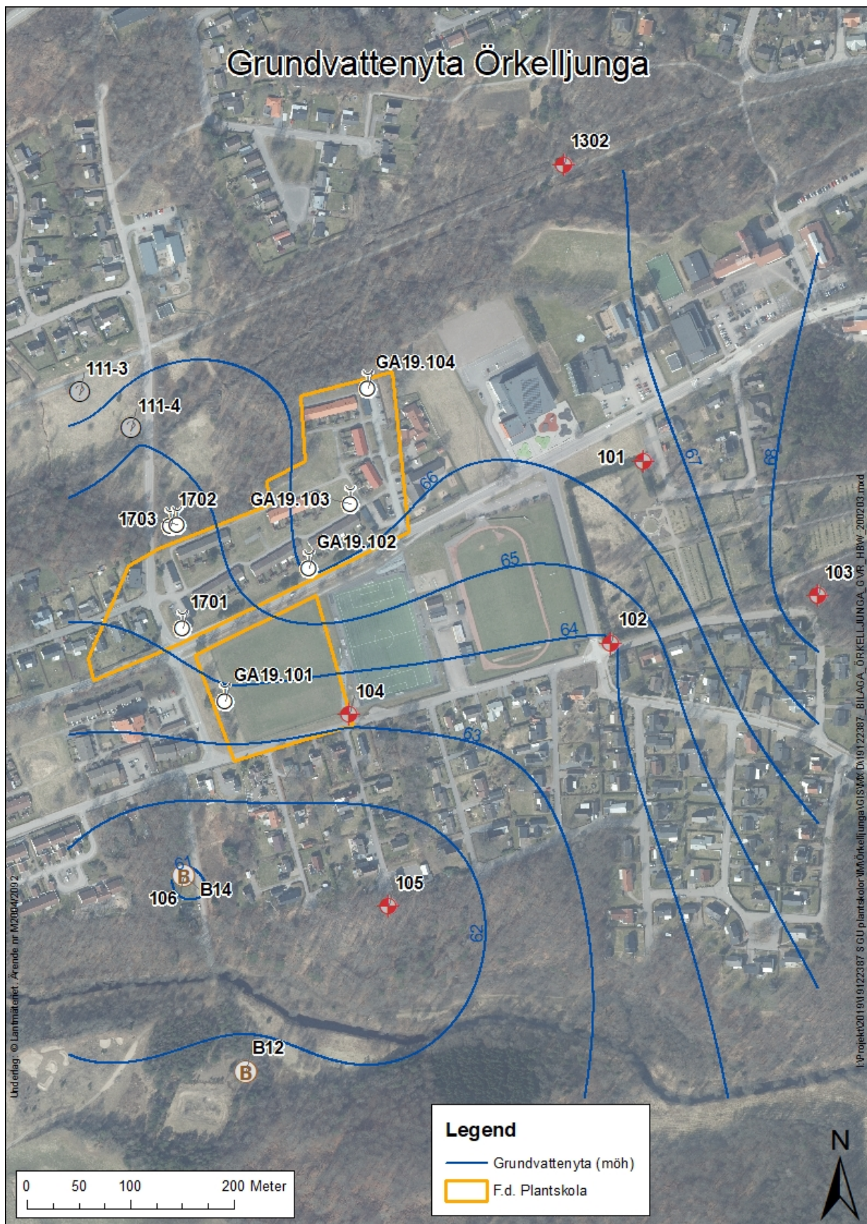
Figur 11, Interpolerad grundvattennivåkarta utifrån grundvattenmätningar genomförda i december 2019.
