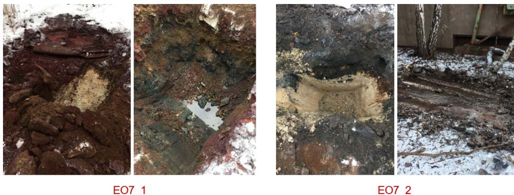
Figur 5.6 Bilder från provgroppgrävning i EO7, delområde EO7_1 och EO7_2, där en betongplatta påträffades över del av ytan (bilden längst t h).
