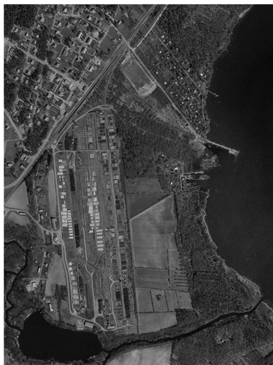
Figur 1. Till vänster Åsbro f.d. gamla impregneringsplats foto från 1947. Impregneringsanläggningen syns i övre delen av bilden. Processvatten pumpades ut i Tisaren, via piren fram till 1945 då en invallning anlades i strandlinjen innanför piren som ett filter. Till höger Åsbro f.d. nya impregneringsplats 1972. Förorenade områden i Estaboån, finns framför allt vid utlopp av en ledning från impregneringstuben i södra delen av verksamhetsområdet (se även figur 3).
