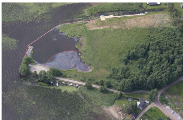
Figur 14. Inre förorenade området i västra Tisaren. Oljefilm och torrlagda sediment innanför länsar under sommaren 2016 (foto Structor)
