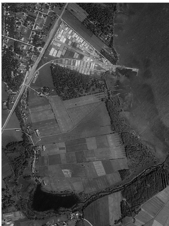
Figur 1. Till vänster Åsbro f.d. gamla impregneringsplats foto från 1947. Impregneringsanläggningen syns i övre delen av bilden. Processvatten pumpades ut i Tisaren, via piren fram till 1945 då en invallning anlades i strandlinjen innanför piren som ett filter. Till höger Åsbro f.d. nya impregneringsplats 1972. Förorenade områden i Estaboån, finns framför allt vid utlopp av en ledning från impregneringstuben i södra delen av verksamhetsområdet (se även figur 3).
