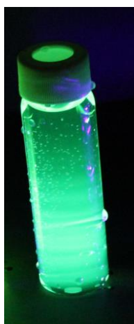
Fig. (2) Billede af visuel fluorescens fra uranin ved belysning med UV lys.
