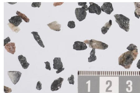
Krossat material från Kållereds-täkten, 2–5 mm.
