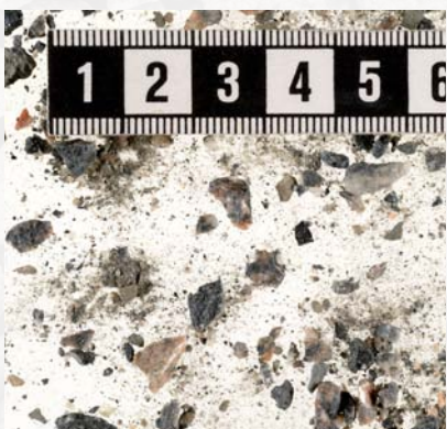
Krossat material från Ludden, Norrköping, 0–4 mm.
